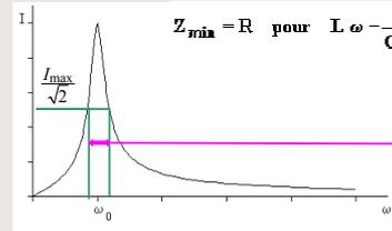
$$Z_{min} = R \text{ pour } L\omega - \frac{1}{C\omega} = 0 \text{ soit } \omega_0 = \frac{1}{\sqrt{LC}}$$
