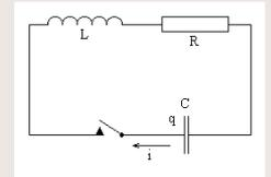
Décharge d'un condensateur à travers une bobine et une résistance
